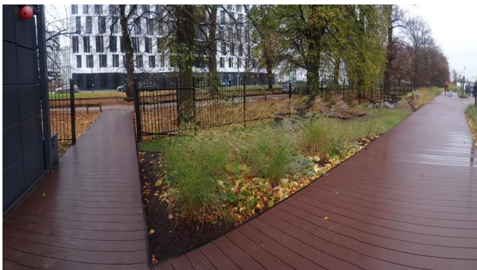
Przykład chodnika rampowego z desek kompozytowych
