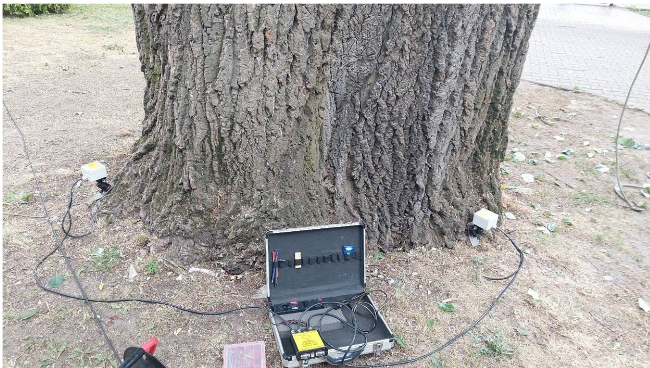
Fot. Rozmieszczenie inklinometrów na badanym drzewie
